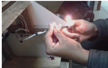
Gambar 16 Pengujian Sensor LM35 Menggunakan Korek Api
